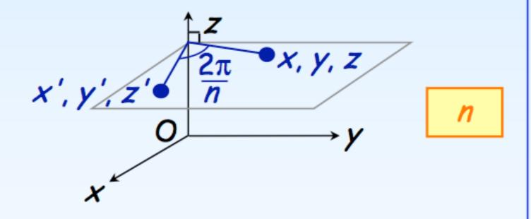
$$\alpha(n) = \begin{pmatrix} \cos\varphi & -\sin\varphi & 0 \\ \sin\varphi & \cos\varphi & 0 \\ 0 & 0 & 1 \end{pmatrix} \quad \text{Det = +1}$$
