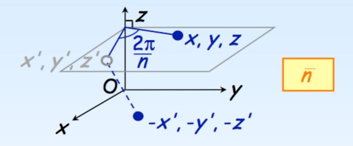
$$\alpha(\overline{n}) = \begin{pmatrix} -\cos\varphi & \sin\varphi & 0 \\ -\sin\varphi & -\cos\varphi & 0 \\ 0 & 0 & -1 \end{pmatrix} \quad \text{Det = -1}$$
